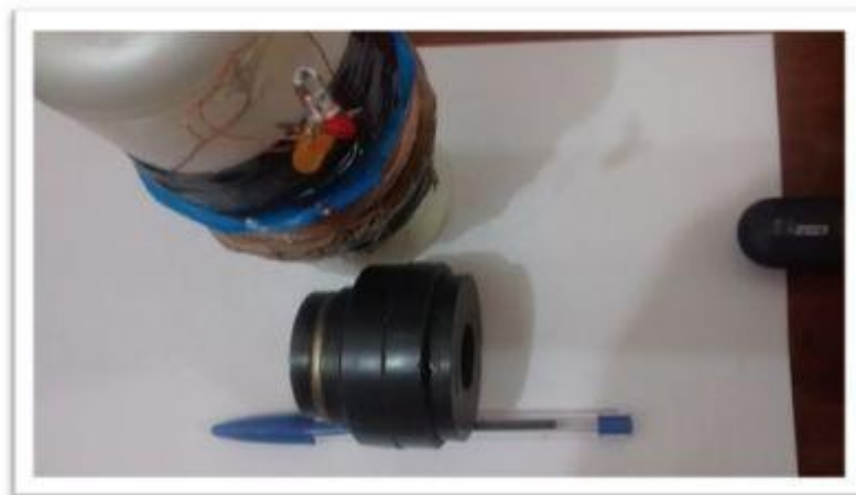
Figura A7 “Minigerador” AC produzido pelos alunos do PROEJA, ao lado dos ímãs de altofalantes. Fonte: Autor.
