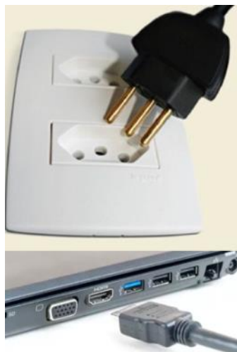
Figura 2 Exemplos de dispositivos PokaYoke do dia a dia. Fonte: Pelos próprios autores (2017).
