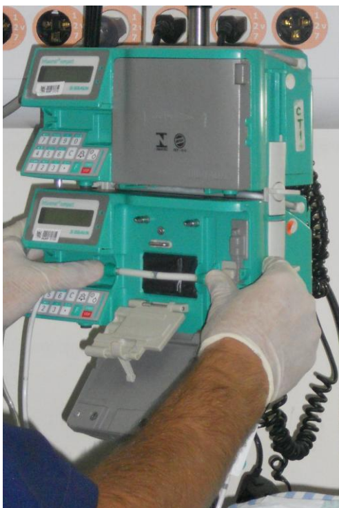
Fig. 11 – Bombas de infusão volumétrica: infusão de medicações por peristalse linear
