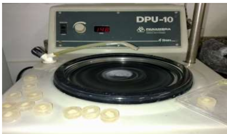
Figura 3 - Politriz com as amostras do ensaio de cisalhamento.
