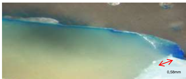
Figura 7 - Mostrando a microinfiltração do corante.
