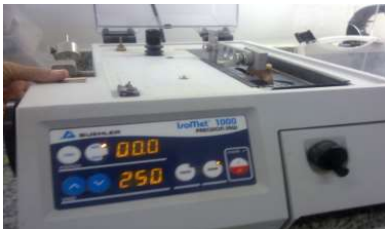
Figura 1 - Cortadeira metalográfica com disco diamantado.
