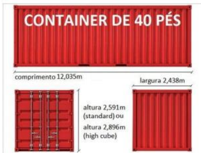
Figura 2 – Medidas do container de 40 pés
