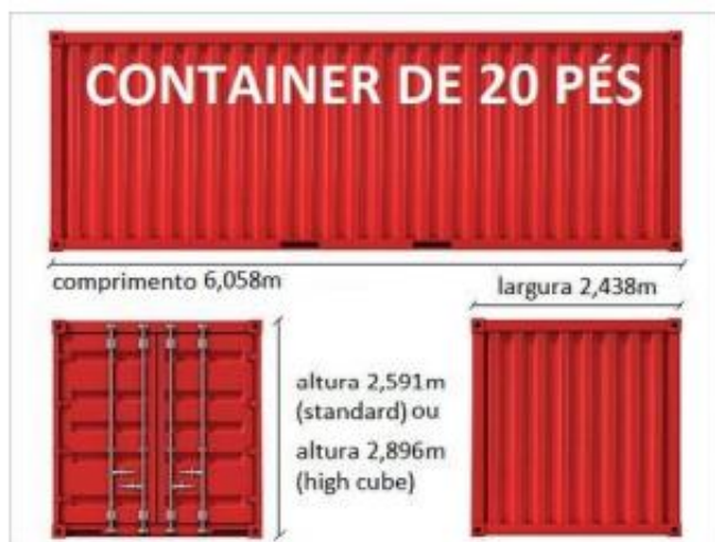
Figura 1 – Medidas do container de 20 pés
