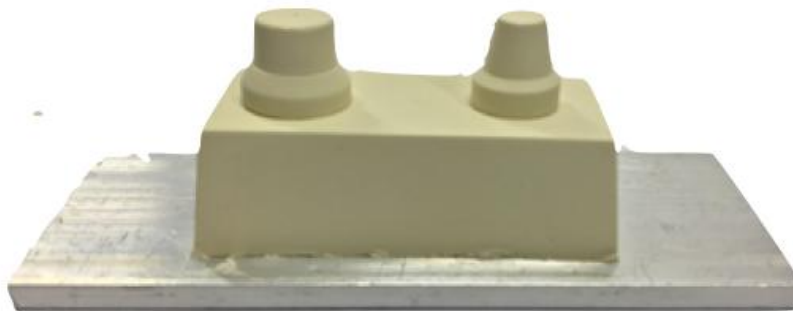
Figura 5. Modelo obtido em gesso tipo IV.
