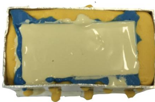
Figura 4. Moldagem após vazar o gesso.
