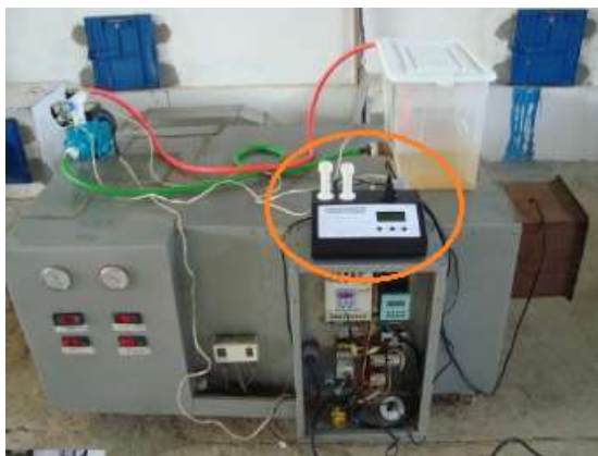
Figura 15 – Imagem lateral da bomba de calor, com sistema de controle. Fonte: Lacerda Filho (2010).
