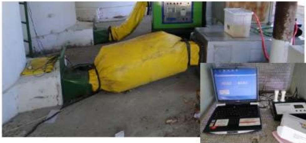
Figura 17 – Bomba de calor conectada ao silo experimental. Fonte: Lacerda Filho (2010).
