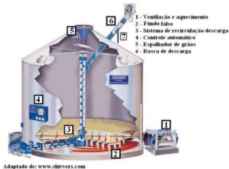
Figura 8 - Sistema de armazenamento com silo-secador em fluxos contracorrentes. Fonte: Silva et al. (2008b).
