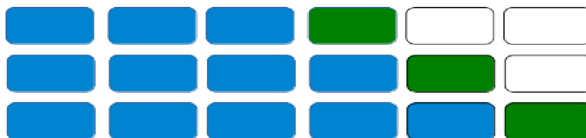
Figura 1 – Exemplo de funcionamento do método de validação cruzada de tamanho 6. Considerar que as amostras estão em ordem temporal da esquerda para a direita. De cima para baixo está a maneira como ela é dividida. Em azul temos o conjunto de treinamento e em verde o conjunto de teste.
