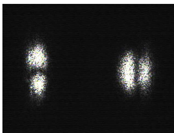
Figura 4.3: As duas saídas do interferômetro de medida para um feixe de entrada com polarização V e modo transversal Laguerre-Gaussiano de primeira ordem.
