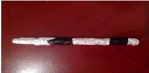
Figura 11: Caneta touch artesanal confeccionada com corpo de caneta e papel alumínio
