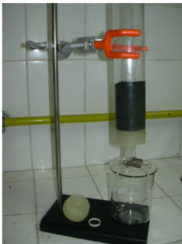
Figura 8 - Esquema mostrando o aparato experimental para o estudo de percolação.
