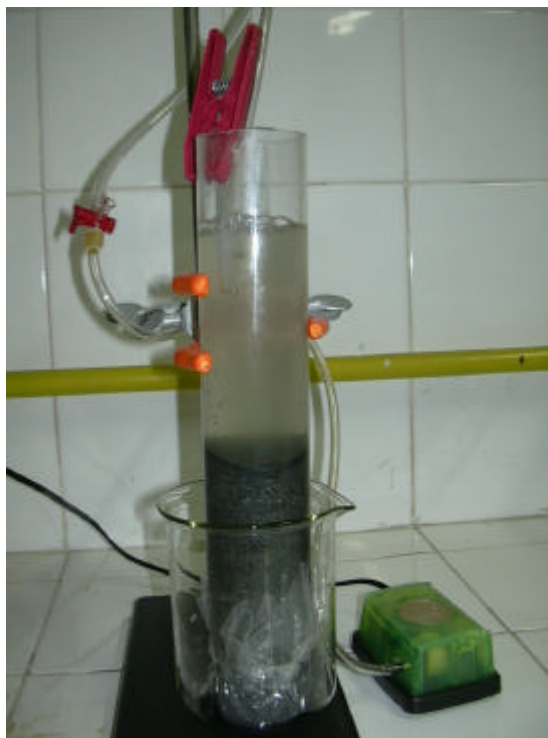
Figura 7- Esquema do aparato experimental utilizado na remoção de iodo.
