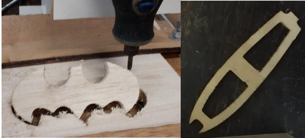
Figura 3.5 – Resultado dos cortes; a) Batman ; b) Perfil aerodinâmico Fonte: Autor (2016)
