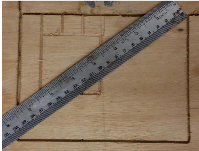
Figura 7.4 – Teste de perpendicularidade com retângulo Fonte: Autor (2017)
