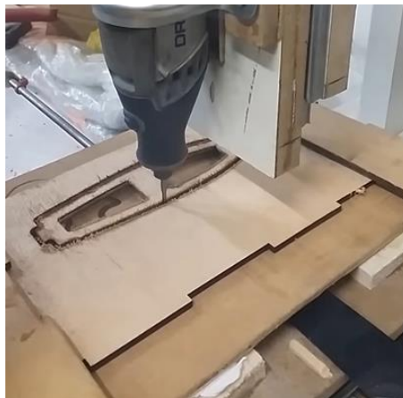
Figura 3.4 – Protótipo preliminar usinando madeira compensado Fonte: Autor (2017)
