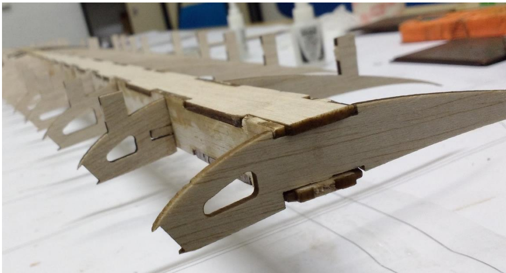
Figura 1.5 – Perfis da asa usinados à laser Fonte: Autor (2015)
